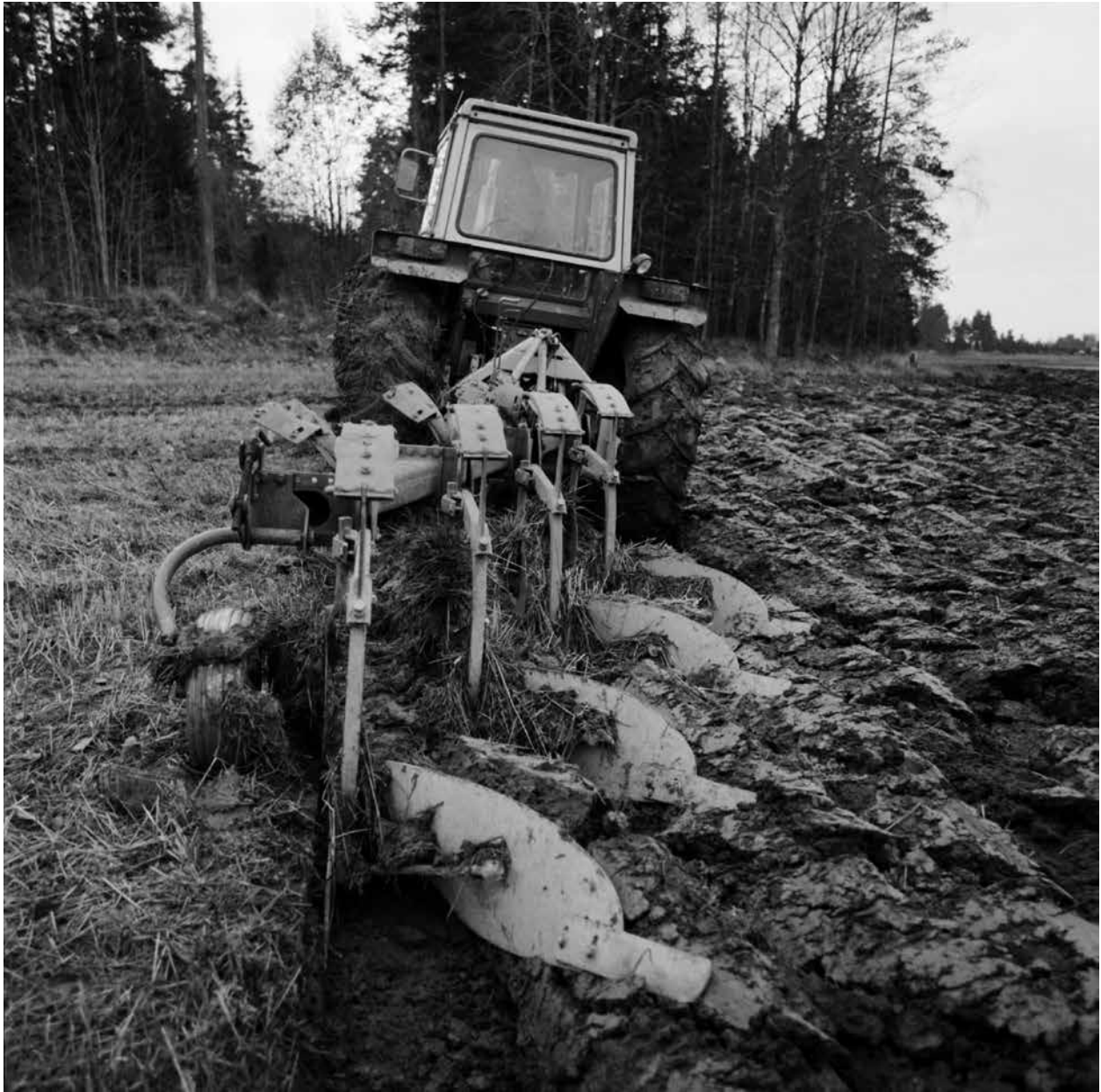
Plöjning med den fyrskäriga hydrauliska plogen på Mellangården i oktober 1981. Foto: Bengt Fredén, Upplandsmuseet
