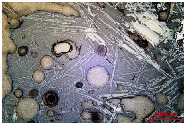
Figur 12N-2297-10: Ljusa olivinlameller varierar i storlek från ca en millimeters bredd (se ljus rektangulär genomskärning i bildens övre högra hörn) till mycket små kristaller som inte går att urskilja i den mörkare mellanmassan av glas. Ingen wüstit eller leucit ses på denna bild. Mikroskopfoto Erik Ogenhall, GAL.
