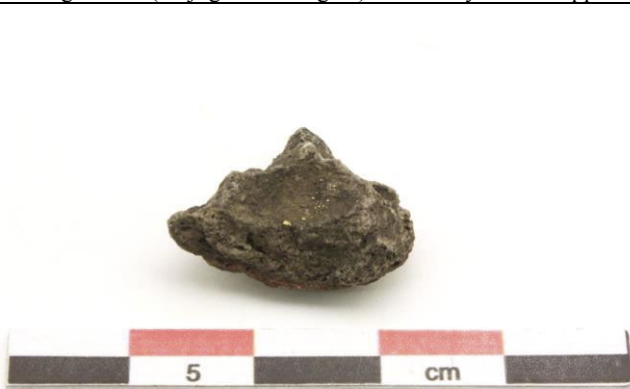
Figur 4-2078-02: Degelfragment med flera metalldroppar på insidan. De två största dropparna är analyserade. Foto Erik Ogenhall, GAL.
