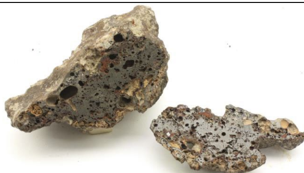
Figur 12S-2575-05: Slaggstycket efter provtagning. Den bortsågade biten preparerades till tunnslip. Notera den plana överytan och den konvexa underytan. Foto Erik Ogenhall, GAL.
