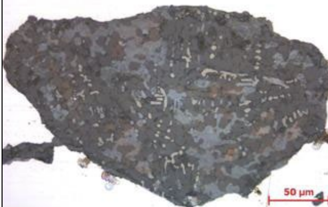
Figur 12S-797-11: De sparsamma och små slagginslutningarna ses bl.a. innehålla ljusgrå dendritisk wüstit och mörkare olivin. Även rost (grå-blå) finns i denna slagg. Mikroskopfoto Erik Ogenhall, GAL.
