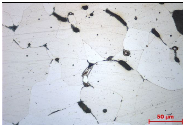
Figur 5-656-11: I mycket hög förstoring framgår att det etsade järnet nästan helt saknar kol. Dock kan brun perlit (kollcementit) observeras i vissa enstaka kornkontakter (mitt i bild). Mikroskopfoto Erik Ogenhall, GAL.
