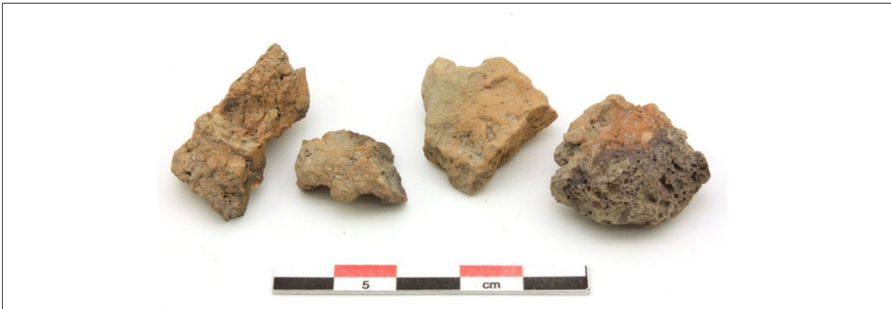
Figur 40. Fodringsfragment från DY 12N. Fragmentet till höger visar värmegradienten från den blåsiga, förglasade insidan (längst ner) till den lägre brända utsidan (längst upp).
