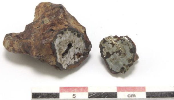
Figur 21-128-06: Fynd 128 sågat för provtagning. Mörka fält i och runt järnet består av rost. Foto Erik Ogenhall, GAL.
