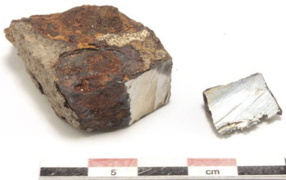
Figur 12S-797-10x: Det provtagna järnet där den mindre biten gjöts in och polerades. Foto Erik Ogenhall, GAL.
