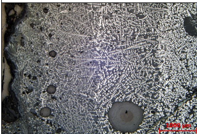
Figur 5-696-10: Till höger i bild ses den ljusa (vita) wüstiten dominera slaggen medan den skiktvis minskar i omfattning till vänster (mot slaggens överyta). Mikroskopfoto Erik Ogenhall, GAL.
