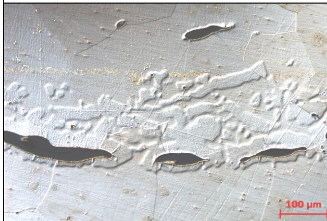
Figur 5-656-12: Slagginneslutningarna i detta järn innehåller endast glas, vilket indikerar att de kommer från vällsand tillsatt under smidet. De flesta ligger dessutom i stråk. Intill slaggen framträder fosforinnehållande järn med högre relief än omgivande järn. Mikroskopfoto Erik Ogenhall, GAL.
