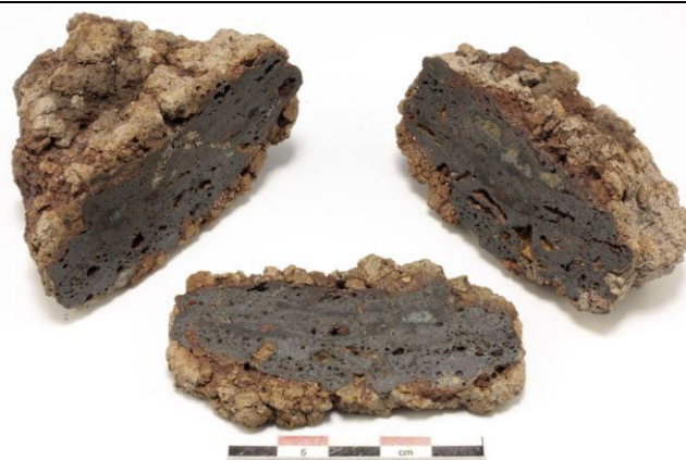
Figur KS-1020-06. När slaggstycket delats ses både de inre skiktade strukturerna, samt ett tvärsnitt som visar att ytterformen är plan-konvex till konkav-konvex. Slaggens överyta är uppåt i bild. Den bortsågade skivan (mitten) preparerades till tunnslip. Foto Erik Ogenhall, GAL.
