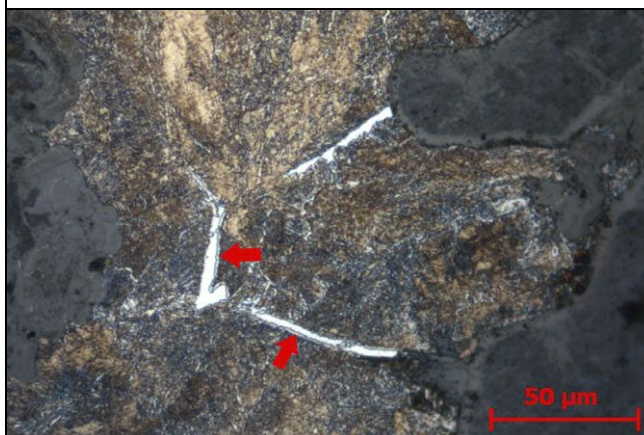
Figur 5-694-12: Efter etsning ses den bruna perliten dominera stålet vilket visar ett högt kolinnehåll. I hög förstoring ses enstaka korngränser innehålla ferrit (vitt kolfritt järn) som ibland har en tunn ljusgrå kant av cementit (järn-kolförening, se röda pilar). Mikroskopfoto Erik Ogenhall, GAL.
