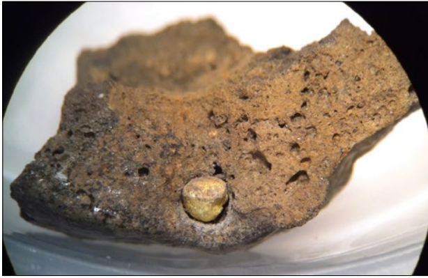
Figur 2. Degel F2074 med en ca 2 millimeter stor droppe insmält i degelväggen längs en brottyta. Fotot är taget genom stereolupp.
