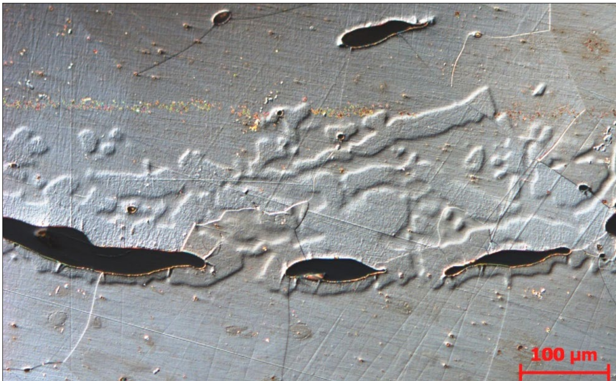
Figur 25. Polerat järnprov 5-656 (ämnesjärn från smedja 3945) i hög förstoring där mörka slaggineslutningar är utdragna, troligen på grund av smide, och där fosfor framträder som en förhöjd relief i järnet, huvudsakligen nära slagen. Det är i det här kolfria järnet även möjligt att se kornkontakterna som tunna raka linjer.
