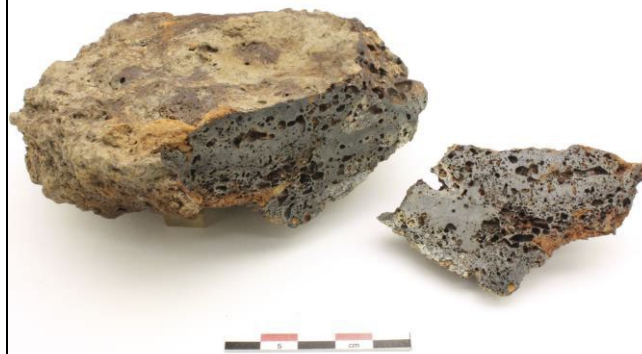
Figur 5-697-06: Slaggstycket efter provtagningsåtgärning. Den plana överytan uppåt och konvexa sidan nedåt. Den bortsågade biten preparerades till tunnslip. Foto Erik Ogenhall, GAL.
