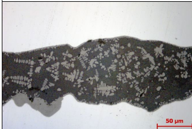
Figur 12N-1356-10: Slaggineslutningarna ses innehålla ljusgrå wüstit som växer dendritiskt i den omgivande mörkare glasfasen. Mikroskopfoto Erik Ogenhall, GAL.
