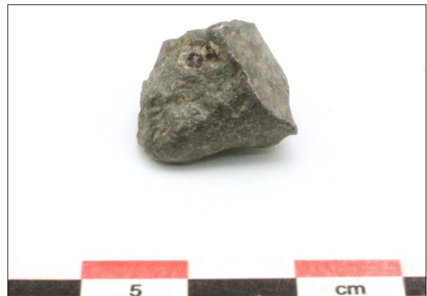
Figur 16. F178, smälta av brons med betydligt ljusare yta, till följd av en betydligt högre tennhalt, än merparten av de analyserade bronserna.
