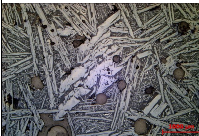
Figur 12N-2233-10: De stora grå olivinlamellerna ligger i en mellanmassa av mindre olivinkrystaller och mörkt glas/leucit. Mikroskopfoto Erik Ogenhall, GAL.
