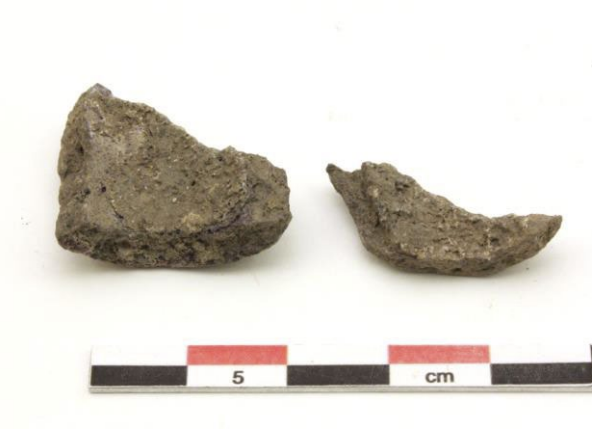
Figur TS17-01: Analysen har utförts på skärvan till vänster. På denna ses tydligt slagghuden på insidan och även en spricka i godset som kan antyda reparationslager. Foto Erik Ogenhall, GAL.
