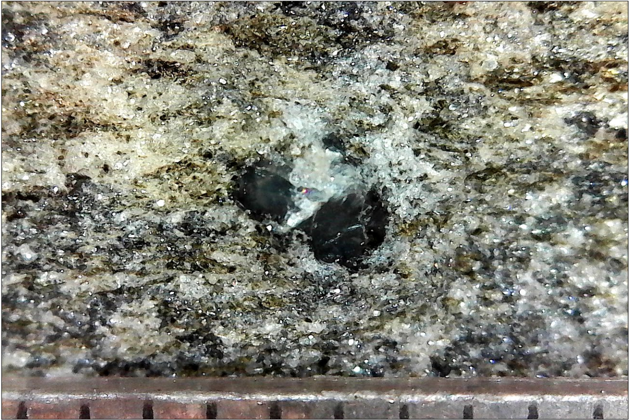
Figur 42. Närbild (lupp) av prov 3026 som ses innehålla enstaka större ströckorn av kvarts (mörka mitt i bild) i en omgivande finkornigare mellanmassa.
