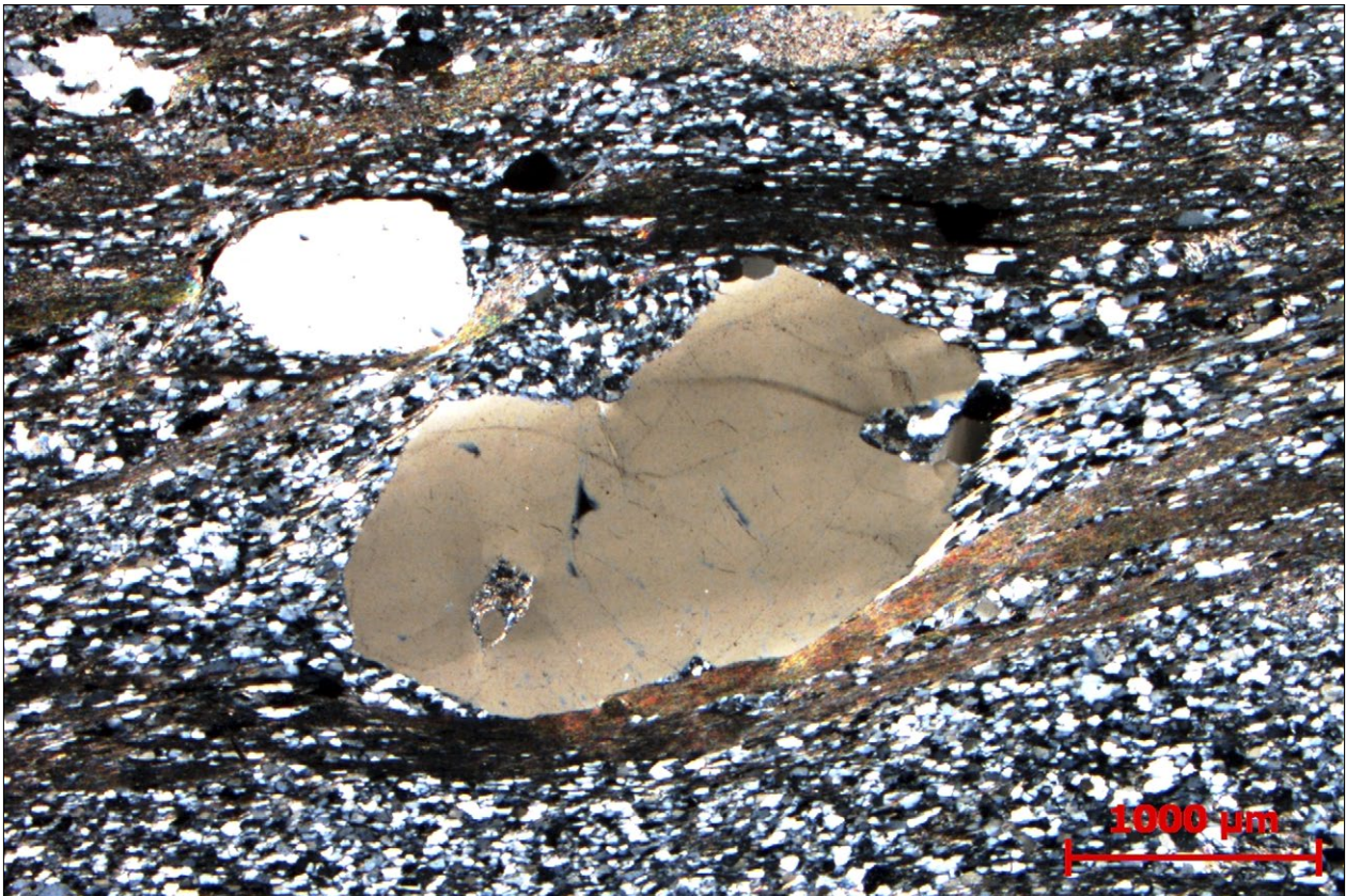
Figur 38. I mikroskop framgår att prov 2712 består av stora strökorn av kvarts i en mycket finkornig mellanmassa av kvarts och glimmer i växelvisa stråk.
