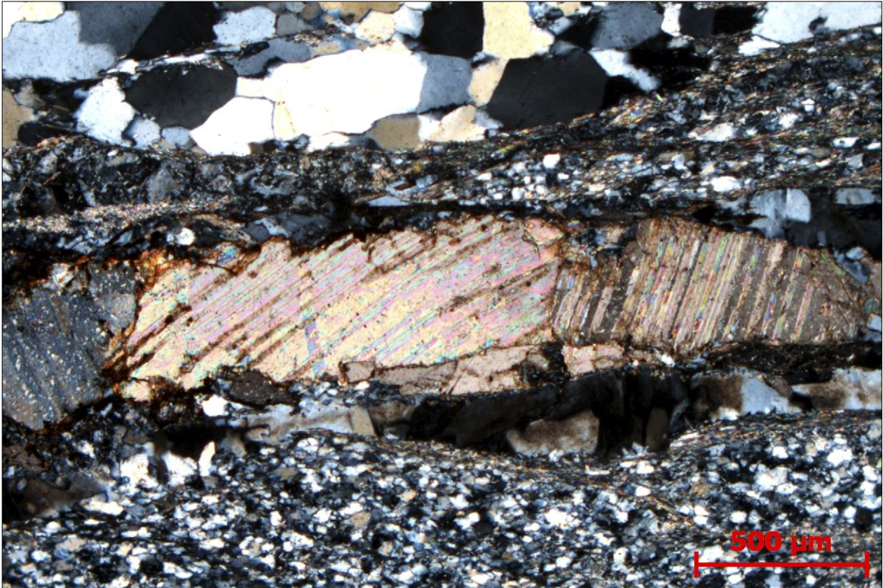
Figur 25. I provet från Sala observerades ett enstaka lager bestående av mineralet kalcit (mitt i bild). Foto från mikroskop.
