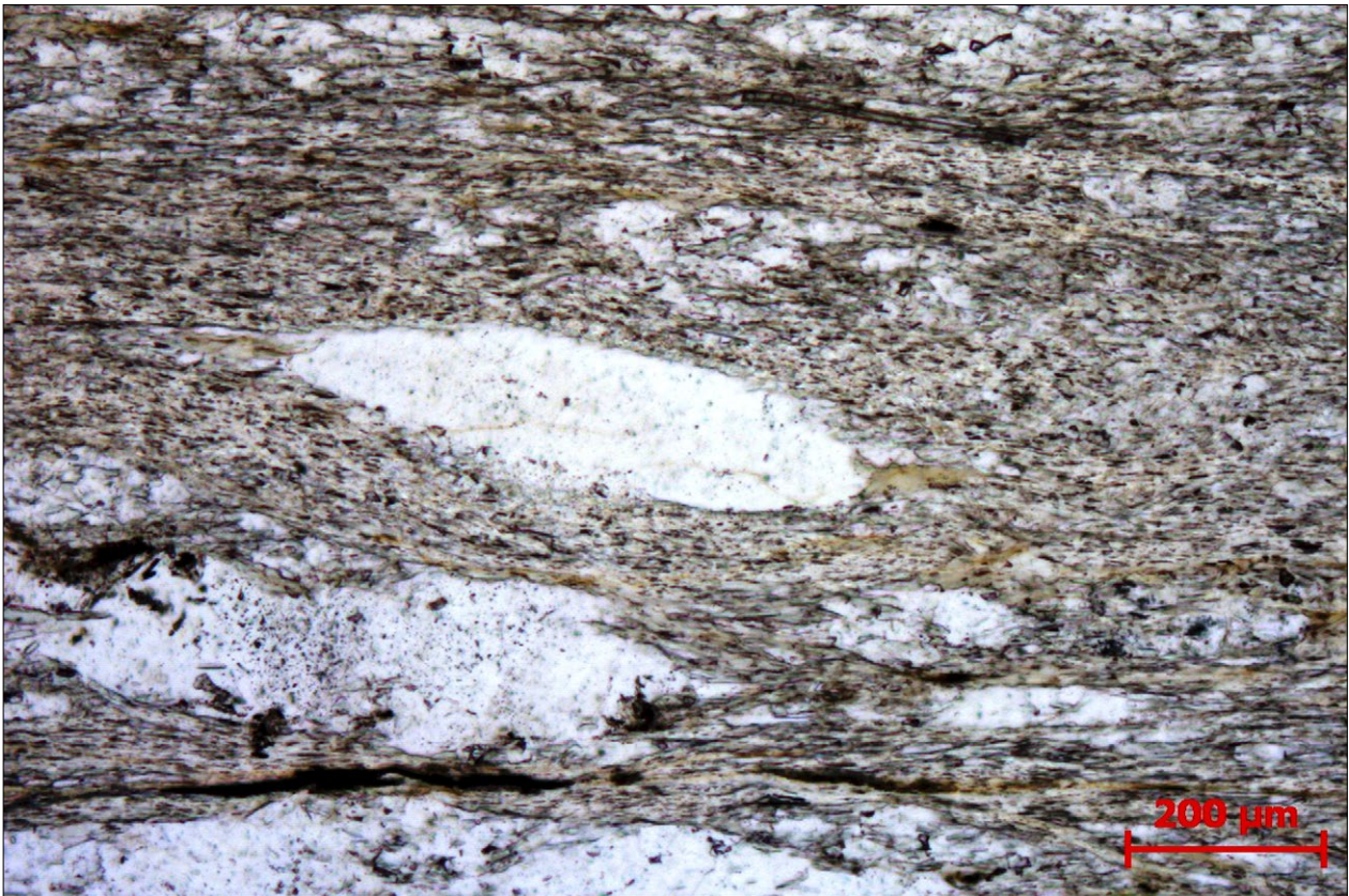
Figur 26. I foto från mikroskop utan polarisationsfilter ses mineralens egenfärg; kvarts är färglös medan glimmern har en blekt grå-gul ton med svaga inslag av grönt. Det senare är möjligen orsak till bergartens gröna färgton.
