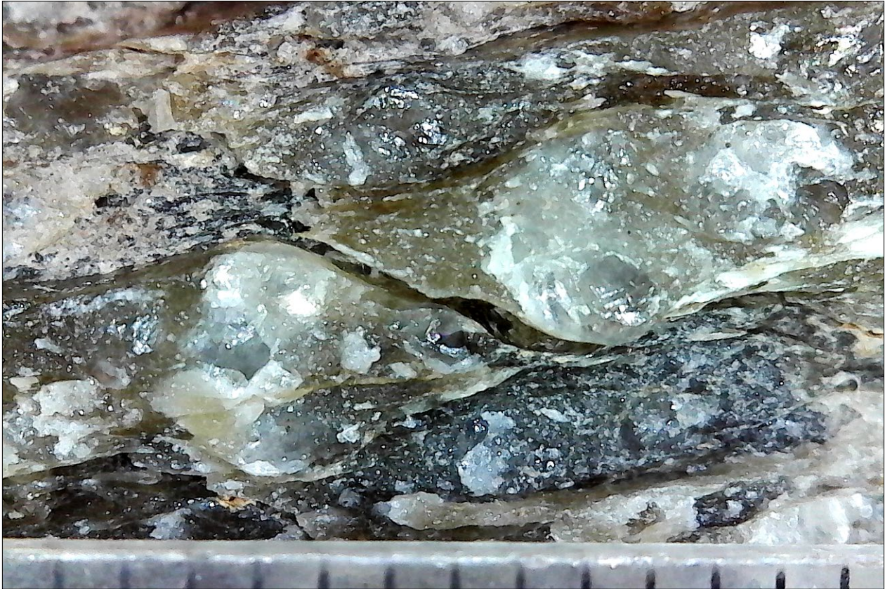
Figur 32. Närbild (lupp) av prov 1993 där rikligt av stora kvartskorn kan ses.
