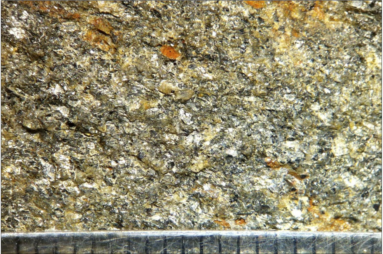
Figur 7. Glimmerskiffern i kvarnstensfragment F4864 är mer finkornig och jämnkornig än övriga glimmerskifferar, samt ses ha roströda inslag möjligen av vittrad pyrit (jämför fig. 6).
