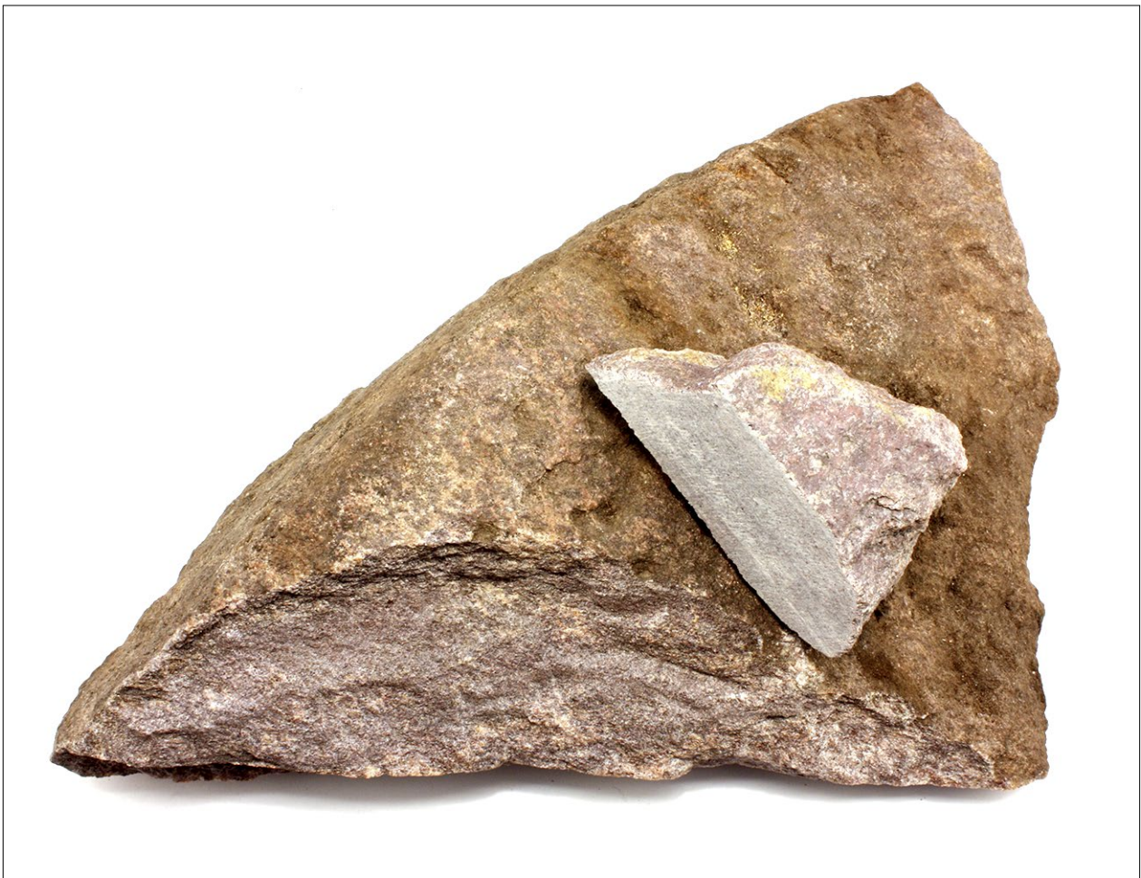
Figur 16. Del av kvarlämnad kvarnsten från kvarnstensbrottet i Malung (Kvarnberget). Den mindre, sågade biten (prov Malung 4) preparerades både till tunnslip och analyserades totalkemiskt. Observera bergartens röda färgton. Den större biten är ca 25×17 cm.
