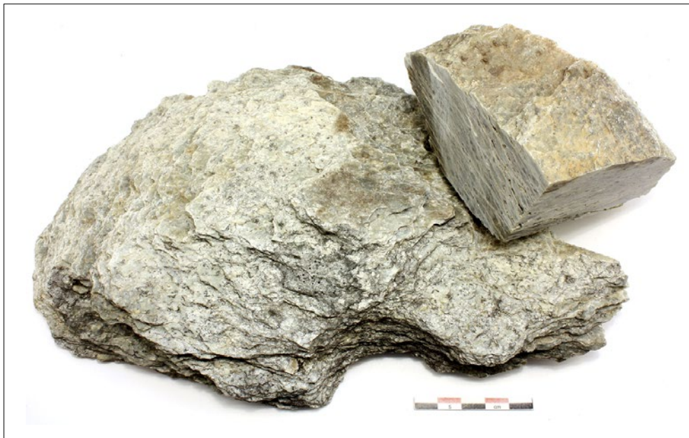
Figur 21. Del av kvarlämnad kvarnsten från kvarnstensbrottet norr om Springargruvorna i Sala. Det mindre sågade stycket preparerades till tunnslip samt analyserades totalkemiskt. Notera bergartens blekt grå-gröna färgton.
