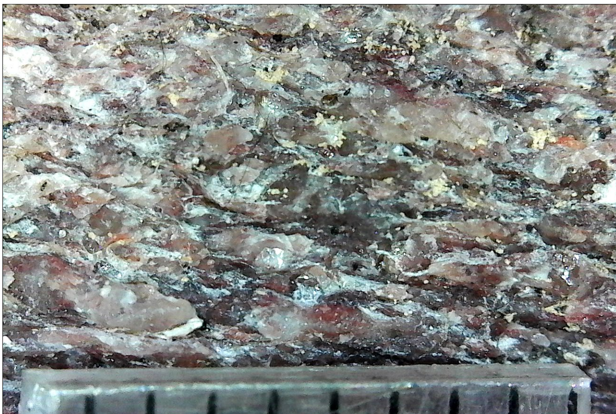
Figur 17. Närbild (i lupp) av ytan på prov Malung 4. Skallstrecken visar millimeter. Den röda färgtonen ses även i mikroskala.
