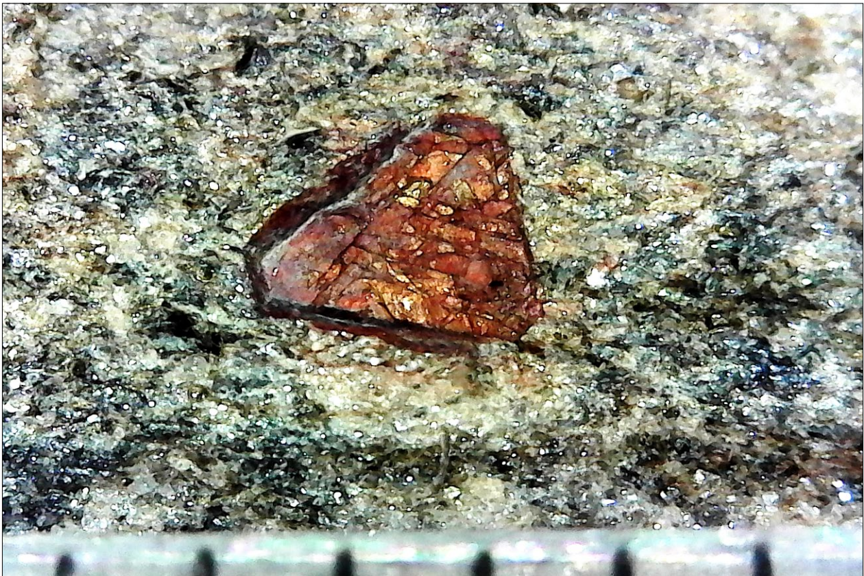
Figur 43. Ytterligare luppbild av ytan på prov 3026 där en av de få kantiga och röd-bruna kristallerna framträder tydligt. Ingen av dessa finns i tunnslipet men den okulära tolkningen är att det är mineralet granat.
