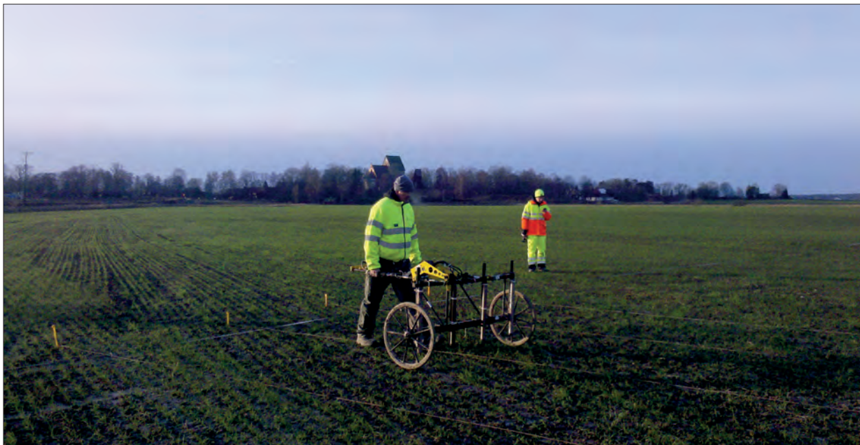
Figur 5. Arkeologernas magnetometersystem bestående av fyra Förstergradiometerinstrument monterade med 50 cm mellanrum på en omagnetisk vagn. Vagnen förs längs 50 meter långa mätprofiler över undersökningsområdet. Mätpunktaavstånd i profilriktning är cirka 10 centimeter. Foto: Maria Lingström, Arkeologerna.
