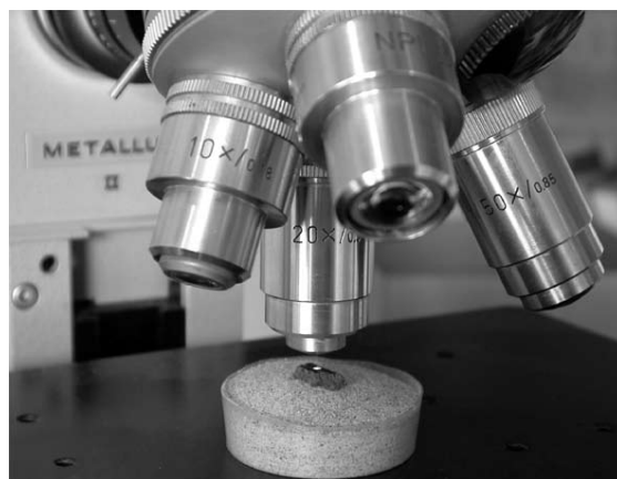
Figur 109. Kolbiten fixeras i tor sand. Belysning sker genom objektivet. Foto: Erik Danielsson/VEDLAB.
