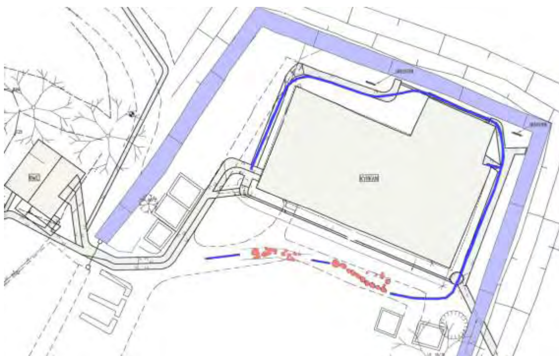
Figur 2. Situationsplan med olika schakt runt kyrkan markerade. Till höger ligger RWC med schakt genom bogårdsmurens grind fram till kyrkans sydvästra hörn. Parallellt med åskledarschaktet ligger ett schakt för dagvatten. Det var i samband med schaktningar för detta som grundstenar framkom. Ljusblå färg markerar bogårdsmuren och mörkblå linje dagvattenschaktets placering. Det sydöstra schaktet ut under bogårdsmuren blev inte av utan dagvattenschaktet förlades i söder framför kyrkan ner mot grinden i bogårdsmuren i väster. De röda stenarna i öster markerar A1, stödmur och de andra i väster A2, vapenhuset.
