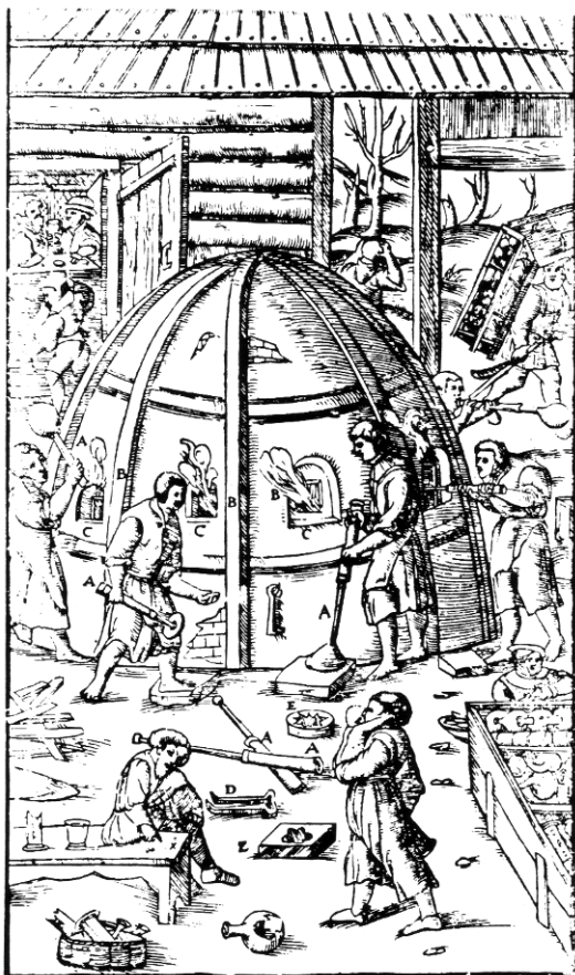
Figur 4. Ugn avbildad vid mitten av 1500-talet. Smältugnen och arbetet vid denna. Tillverkning av passglas och buteljer. Efter Thor 1989.
