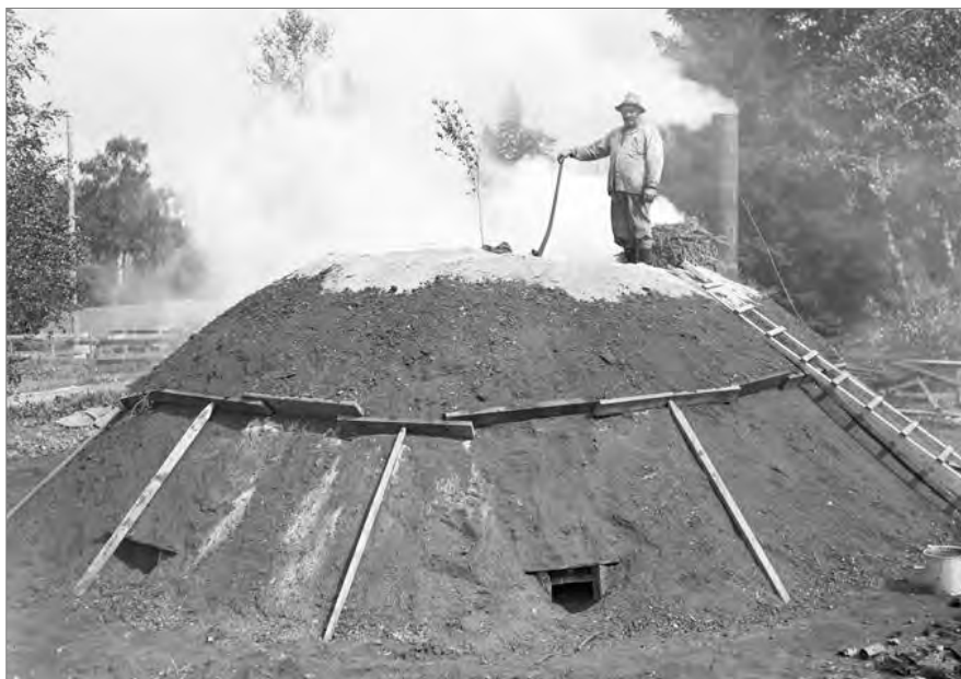
Figur 5. Kolare på sin mila i augusti 1940. Milan är en s.k. resmila som har försetts med skorsten. En stor del av träkolsframställningen under krigsåren gick till ombyggda gengasdrivna fordon, då stor brist på bensin rådde. Foto Paul Sandberg, Upplandsmuseets bildarkiv.
