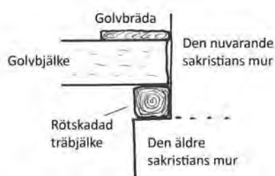
Figur 26. Principskiss för den östra källarmuren. Skala 1:20.
