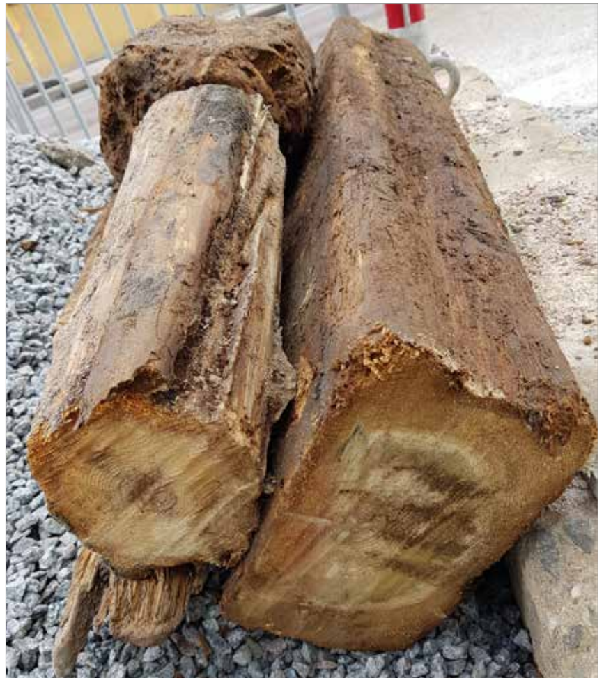
Figur 124. Virke från träledningen i Kungsgatan (A3, schakt 4). Dendroprov 1 (till vänster) samt prov 3, troligen återanvänt väggtimmer (till höger). Prov 1 kunde dateras till 1845. Dateringen av prov 3 var mer osäker, men fällningsåret är här beräknat till mellan 1811 och 1841. Foto Linda Qviström/Upplandsmuseet.
