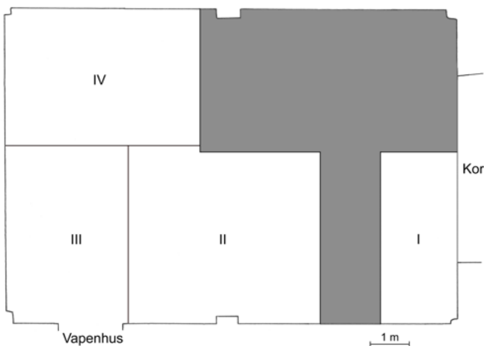
Figur 5. Långhuset undersöktes uppdelat i fyra ytor. Yta IV undersöktes först flera veckor efter övriga ytor. Grå yta markerar sentida källare och värmekanal. Skala 1:100.
